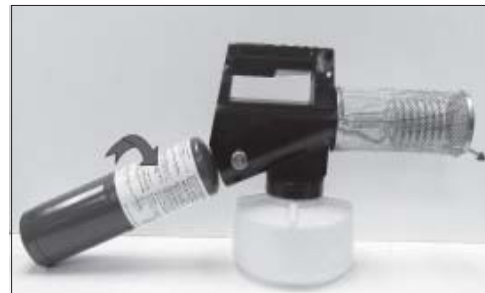
Imagen 5 Cilindro de gas propano
